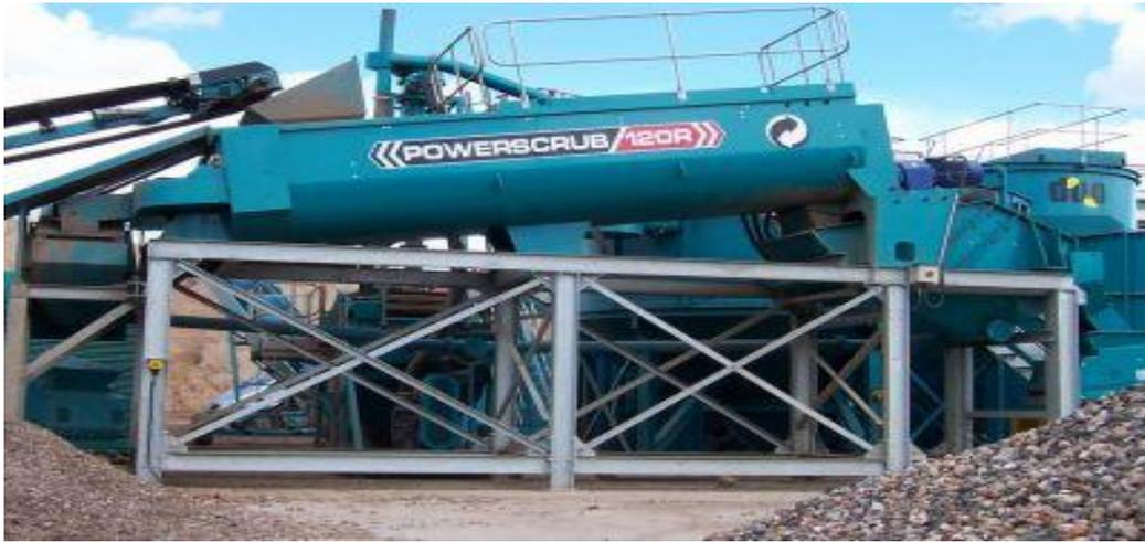
**Fig. 2.13** Powerscrub 120R crushing machine
